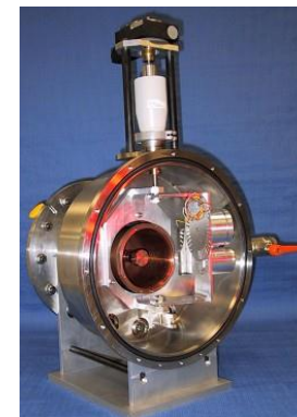
Banc de caractérisation de réponse angulaire de détecteurs
